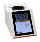
熔点仪是运用光电检测、数字温度显示等技术,应用线性校正的 铂金电阻作为检测元件来检测物质熔点的实验分析仪器。有机化 学领域中,熔点的测定是辨别物质纯度的重要方法之一。公司的 熔点仪产品可广泛应用于化学工业、医药研究等领域,是生产药 物、香料、染料及测量其他有机晶体物质熔点的工具之一。
