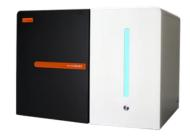
公司的杜马斯定氮仪可用于测定食品、谷物(粮食)、饲料等样品的**蛋白质**含量以及车用尿素、肥料和土壤中总氮的含量。检测过程快速高效,单个样品分析时间从传统方法的120min 缩短到 3-4min,且通过内置自动进样器可实现连续做样及无人值守,在高通量的基础上节省人力。使用杜马斯定氮仪进行样品测试,反应过程无需使用浓酸浓碱,也不会产生酸雾,安全环保。
